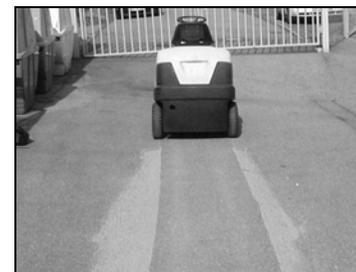
— Подметание с помощью цилиндрической щетки
