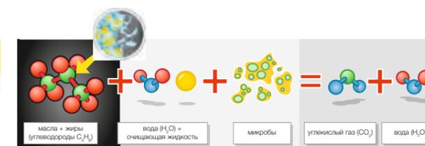
Биологический процесс чистки под микроскопом: обработка водным раствором чистящего средства с содержанием микроорганизмов обеспечивает биологическое разложение органических веществ на углекислый газ и воду.
