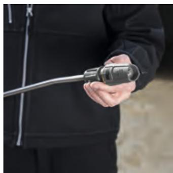
Трехпозиционные сопла Kärcher сочетают универсальность с высокой эффективностью очистки. Прочные высококачественные сопла из нержавеющей стали отличаются длительным сроком службы и позволяют выбирать струи 3 видов: точечную высокого давления (угол распыления 0°), веерную (25°) высокого давления и веерную (40°) низкого давления, обеспечивающую всасывание и нанесение чистящего средства. Контур мощного сопла гарантирует высокую эффективность веерной струи высокого давления.
