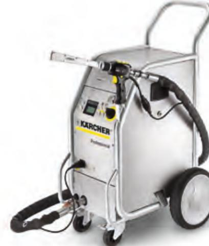
Струйная обработка гранулами сухого льда – идеальный метод для бережной очистки чувствительных поверхностей. Компактный аппарат IB 7/40, рассчитанный на подключение к обычным производственным пневмосетям, обеспечивает превосходную очистку уже при давлении сжатого воздуха 2 бар.
