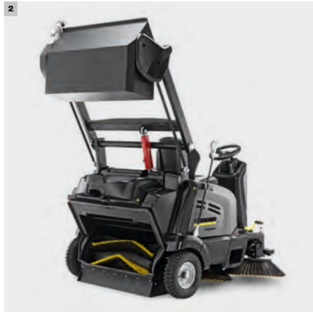
**2** Гидравлическая разгрузка бункера
