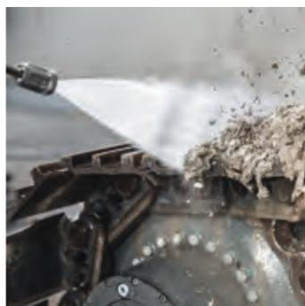
Мощные сопла Kärcher гарантируют быструю и тщательную очистку больших поверхностей. Формируемая ими струя воды, состоящая из летящих с большой скоростью крупных капель, обеспечивает значительное (до 40 %) повышение ударной силы.
