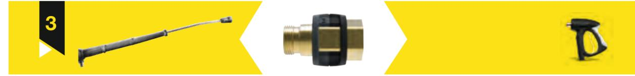
EASY!Lock – M 22 x 1,5 № д. зак. 4.111-031.0 Адаптер для соединения пистолетов с разъемом M 22 x 1,5 и струйных трубок или регуляторов Servo Control с разъемом EASY!Lock.
