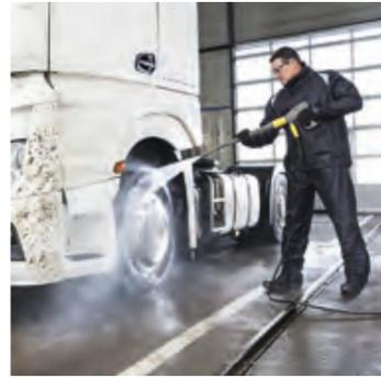
Струйные трубки Kärcher разной длины, изготовленные из высококачественной нержавеющей стали, поворачиваются на 360° под давлением. Их эргономичные рукоятки и большие резьбовые разъемы обеспечивают удобство в обращении и хорошую изоляцию. Возможности аппаратов высокого давления значительно расширяются специальными струйными трубками. Например, гибкая струйная трубка позволяет удобно очищать труднодоступные места, а телескопическая – потолки и фасады.
