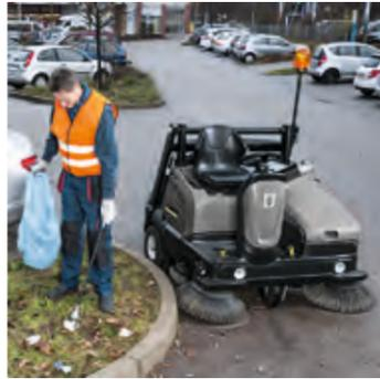
Продуманная система закрепления дополнительного инвентаря повышает эффективность применения наших подметальных машин при решении повседневных задач уборки. Различные крюки, зажимы и емкости, устанавливаемые на корпусе машины, позволяют перевозить как ручной уборочный инвентарь (щипцы для крупного мусора, метлу, совок, ведро, салфетки, чистящие средства и т. д.), так и, например, бутылку с напитком.
