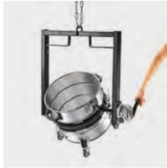
Специальное приспособление позволяет легко и быстро разгружать заполненные мусоросборники весом до 260 кг при помощи крана или погрузчика.
