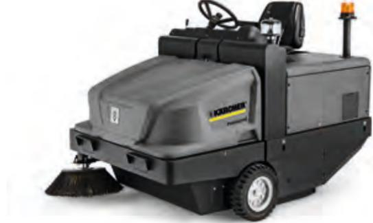
Машина KM 120/250 R в любых вариантах привода (аккумуляторном, с дизельным или газовым двигателем) прекрасно подходит для уборки на промышленных предприятиях и одинаково эффективно справляется как с крупным строительным мусором, так и с мелкой пылью. При этом большой карманный фильтр гарантирует удаление больших объемов мусора без подъема пыли. Управление машиной с гидравлическим приводом всех агрегатов производится очень легко – при помощи эргономичных рычагов.
