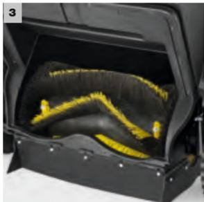
**3** Расположение цилиндрической щетки на задней оси машины
