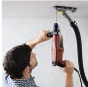
Насадка-пылеуловитель, совместимая со всеми пылесосами сухой или влажной и сухой уборки Kärcher, позволяет высверливать отверстия без запыления окружающего пространства.
