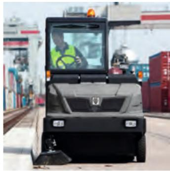
Для работы на объектах, требующих принятия дополнительных мер защиты оператора от падающих предметов (например, на складах с многоярусными стеллажами), машины могут дооснащаться защитными навесами или кабинами (по желанию оборудованными также отопителем и кондиционером). Безопасность выполнения работ на производственной территории увеличивают также проблесковые маячки, повышающие заметность машины для окружающих.
