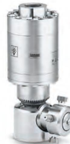
Наша инновационная самоприводная моечная головка из нержавеющей стали разработана специально для очистки внутренних поверхностей автомобильных и железнодорожных цистерн, а также 20-футовых танк-контейнеров. Она имеет сертификат взрывозащитности, в высшей степени устойчива к щелочам, кислотам, растворителям и деминерализованной воде и обеспечивает стабильную работу в различных режимах (при разных значениях давления и частоты вращения).
