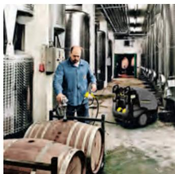
В программе принадлежностей Kärcher для аппаратов высокого давления есть и решения, гарантирующие превосходную очистку внутренних поверхностей самых разнообразных емкостей. Например, разбрызгивающие головки серии НКФ эффективно очищают любые резервуары объемом до 3000 л с отверстиями диаметром 50 мм и более, а приспособление ВС 14/12, разработанное специально для чистки дубовых бочек, не только тщательно промывает их, но и откачивает загрязненную воду.
