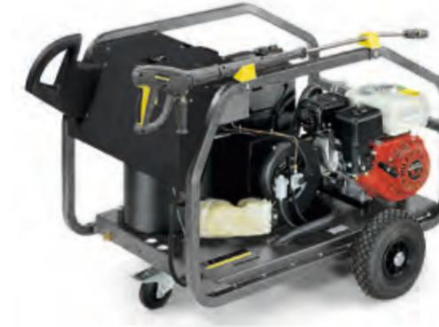
Мобильные аппараты начального уровня оснащаются мощным и экономичным бензиновым или дизельным двигателем и обеспечивают высокий уровень безопасности (в частности, благодаря наличию предохранительного клапана).
