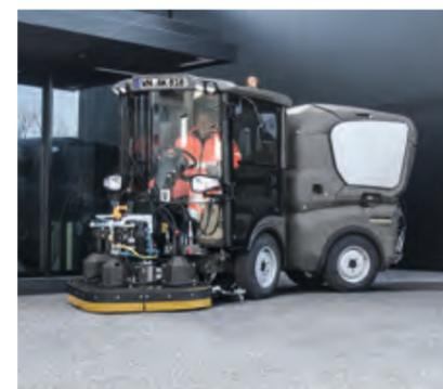
MC 130 с поломочным агрегатом
