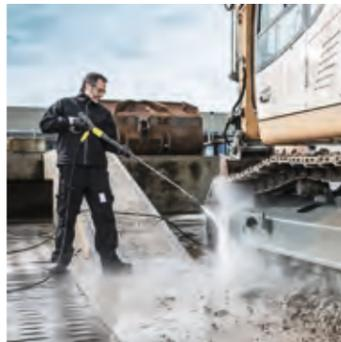
Грязевая фреза Kärcher сочетает преимущества точечного и веерного сопел. Струя, вращающаяся вокруг собственной оси с частотой порядка 4000 об/мин, обеспечивает высокую интенсивность очистки и высокую производительность по площади.
