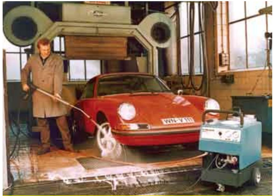
Мойка автомобиля аппаратом HDS 750 с последующей автоматической сушкой
