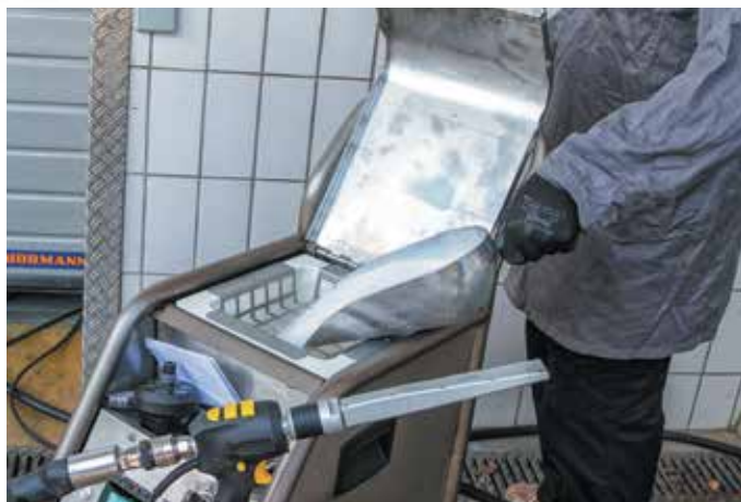
Загрузка контейнера IB 7/40 сухим льдом
