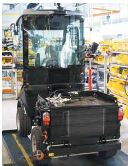
Сборка подметальной машины производится полностью вручную
