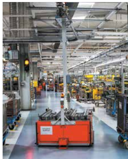
Роботизированная тележка доставляет комплектующие без участия человека
