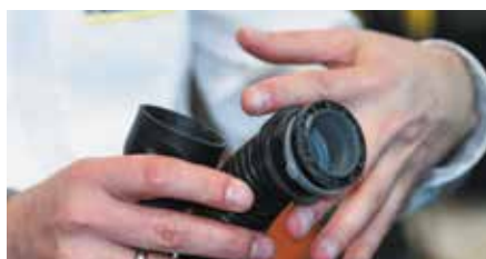
... если же после многократных деформаций образовался разрыв, его легко устранить, укоротив шланг
