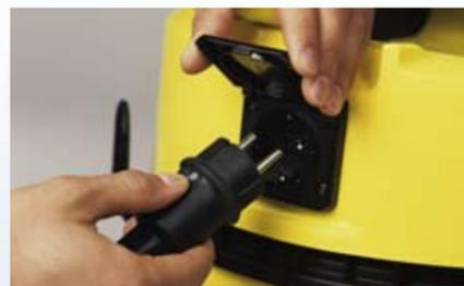
Версия аппарата рт оснащается штепсельной розеткой, позволяющей подключать электроинструмент. Тем самым обеспечивается немедленное всасывание образующейся пыли. Максимальная мощность подключаемого инструмента – 2100 Вт.
