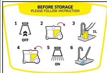
На головке устройства имеется наклейка, описывающая, как очистить устройство после работы:
