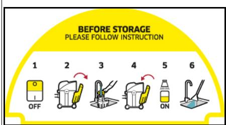
На полке устройства имеется наклейка, на которой описано, как очистить устройство перед хранением:
