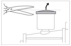
→ Перед первым использованием срезать кончик на колпачке емкости с маслом водяного насоса.
