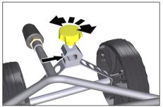
→ Задвинуть разбрызгивающую штангу в крепление ходовой части.
