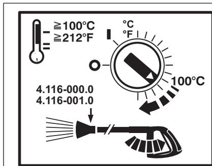
При рабочих температурах выше 100 °C поменять форсунки высокого давления на паровые форсунки.
