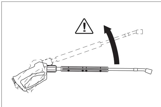
Из-за струи воды, выходящей из струйной трубки, возникает сила отдачи. Из-за того, что струйная трубка расположена под углом, сила действует вверх.
