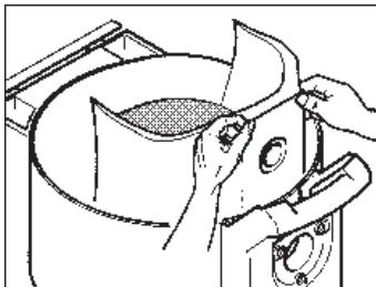
**Важное указание:** следите за тем, чтобы фильтр был вставлен правильно, в противном случае есть опасность повреждения турбины.
