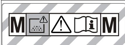
**ПРЕДУПРЕЖДЕНИЕ:** В данном устройстве находится опасная для здоровья пыль. Опорожнение и техническое обслуживание, в том числе удаление пылесборного мешка, должны выполняться только специалистами, имеющими соответствующее защитное снаряжение. Не включать до полной установки системы фильтрации и проверки функционирования контроля объемного потока.
