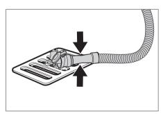
→ Слить грязную воду, открыв дозирующее устройство на сливном шланге.
