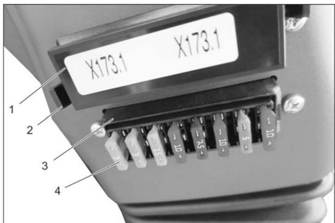
Основные предохранители находятся справа под рулевым колесом.
