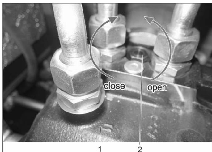
Для перемещения/буксировки устройства сначала необходимо открыть механизм свободного хода (байпас) гидравлического насоса.
