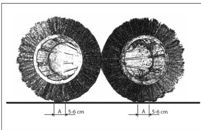
→ Плоскость подметания должна составлять 5-6 см. Плоскость подметания (давление прижима щеток) устанавливается с помощью поворотного потенциометра на панели управления.
