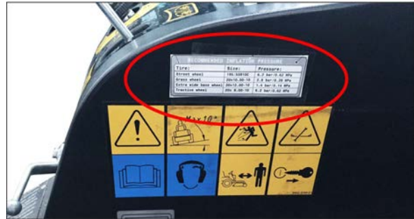
Рисунок: Наклейка в кабине водителя с рекомендованным давлением в шинах
