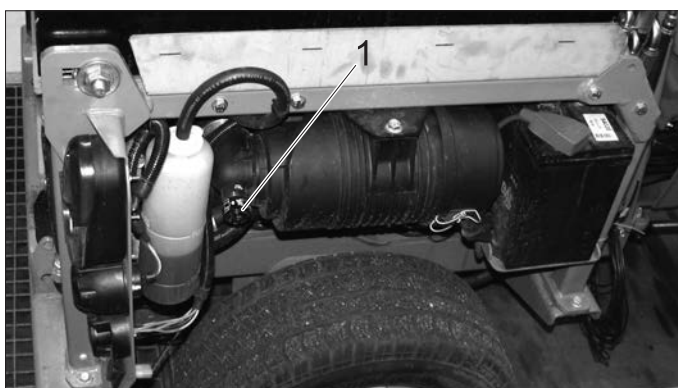
1 Индикатор замены воздушного фильтра
