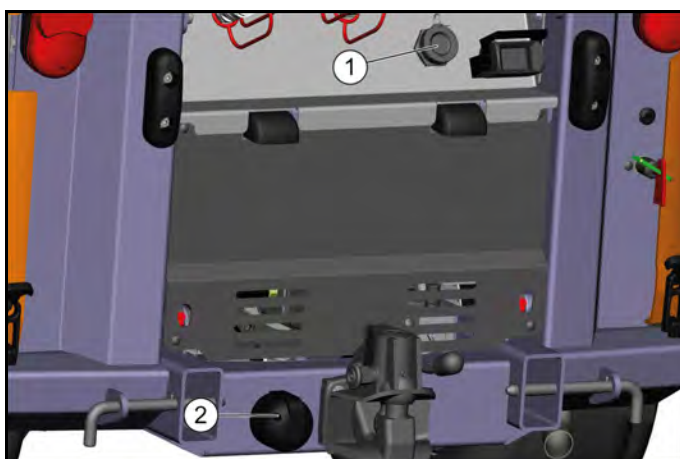
① Электрическое подключение AUX 1 для заднего навесного устройства (21-контактная розетка)
