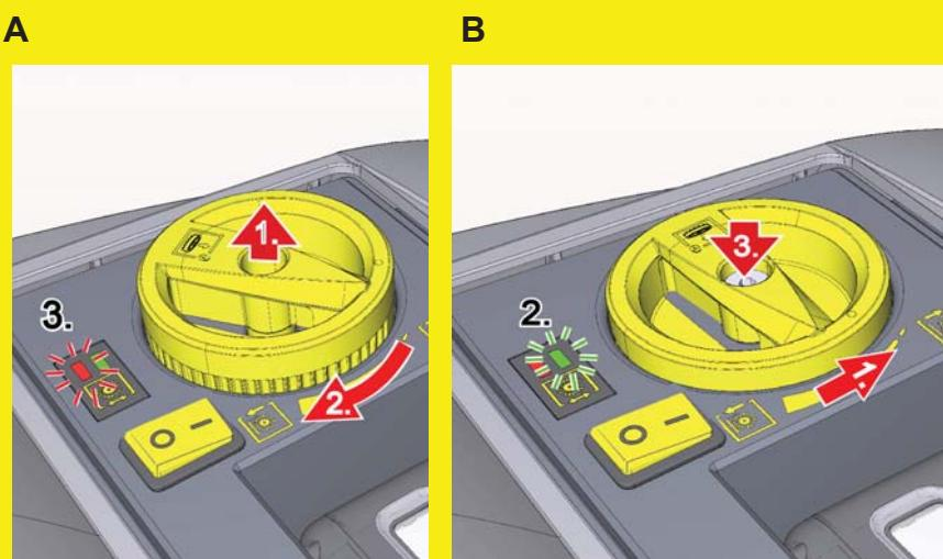
**Регулирование цилиндрической щетки**
