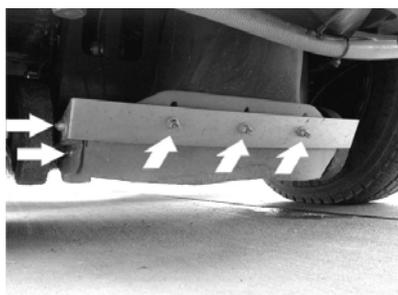
Регулировка уплотнительной планки:
