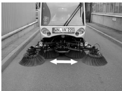
В зависимости от степени загрязнения поверхности передние боковые щетки можно выдвинуть или вдвинуть.
