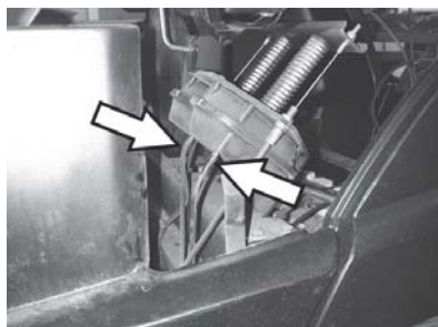
Элемент подключения шланга для мембранного механизма вакуумного регулятора подметающего вала.
