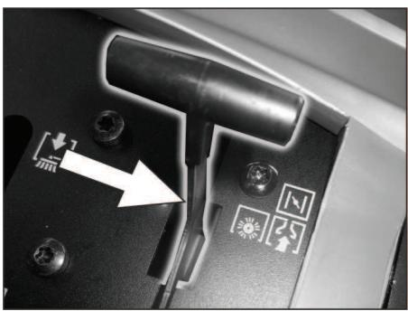
→ Многофункциональный рычаг сдвинуть в среднее положение „Рабочее число оборотов“, при холодных или влажных погодных условиях - в положение „Дроссель“.
