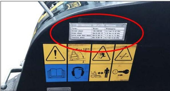
Рисунок: Наклейка в кабине водителя с рекомендованным давлением в шинах
