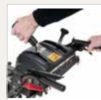
БЛОКИРОВКА РУКОЯТКИ И КУРКИ УПРАВЛЕНИЯ ПОВОРОТОМ
