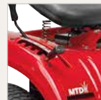
РУЧНАЯ РЕГУЛИРОВКА ВЫСОТЫ СКАШИВАНИЯ И РУЧНОЕ ВКЛЮЧЕНИЕ ПРИВОДА НОЖЕЙ
