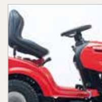
ОТКРЫТАЯ РАМА УДОБНА ДЛЯ ПОСАДКИ И ВЫСАДКИ ОПЕРАТОРА
