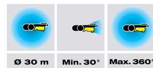
Импульсный секторно-круговой дождеватель орошает участки площадью до 706 м 2 .
