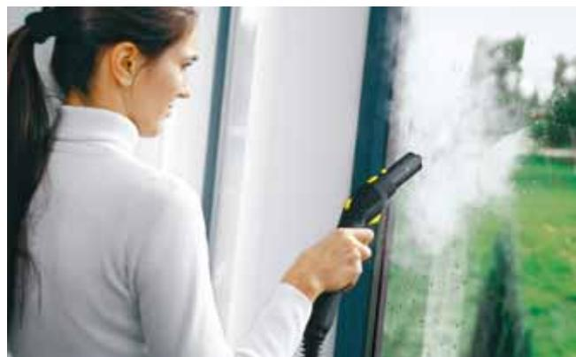
2. Затем при помощи щетки для точечной струи обдайте поверхность окна паром сверху вниз.
