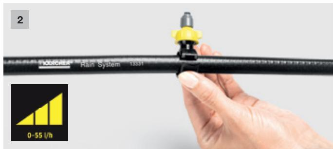
Отрегулируйте расход воды поворотом головки форсунки (в пределах 0–55 л/ч).
