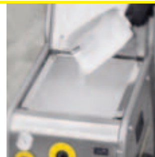
3-миллиметровые гранулы сухого льда, используемые для загрузки в аппарат
