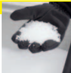
3-миллиметровые гранулы сухого льда, используемые для загрузки в аппарат
