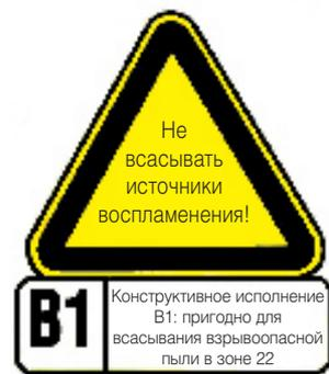
**Зона 22:** участок, на котором при нормальных условиях работы обычно не формируется или лишь кратковременно формируется взрывоопасная атмосфера в виде воздушного облака, включающего горячую пыль (определение из директивы АТЕХ 94/9/ЕС).
