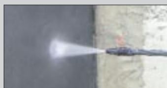
Nilfisk-ALTO C 120.1-6. Насадка с вращающейся струей
