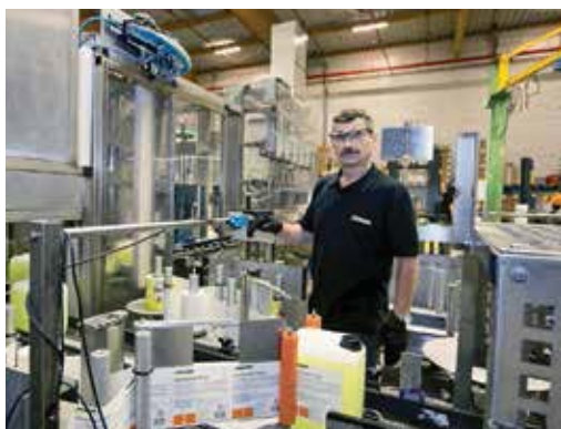
Анатолий Вайцель управляет системой, которая заполняет чистящими средствами канистры емкостью от 2,5 до 20 литров.
