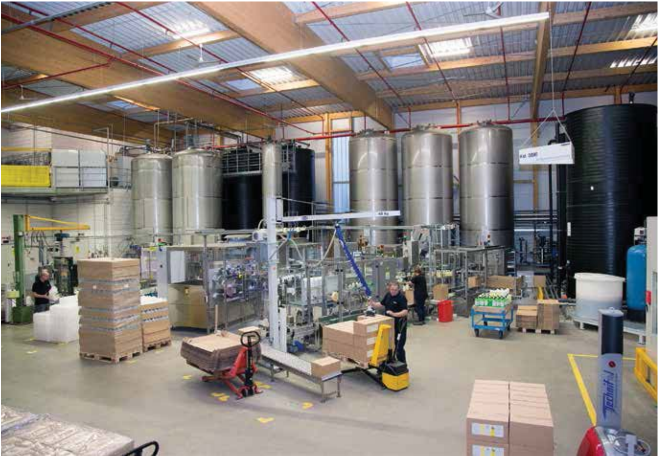
Чистящее средство хранится в шестиметровых цистернах, откуда подается в системы наполнения (на переднем плане).
