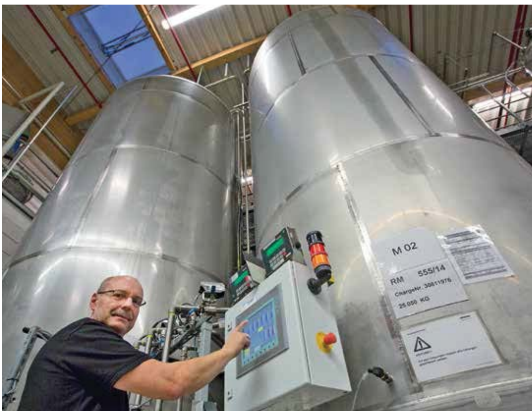
В пяти цистернах объемами 25 000, 10 000 и 3000 литров моющие средства смешивают в соответствии с формулами, созданными в лаборатории разработки в Виннендене. За процессом следит сменный мастер Эдгар Вульф.
