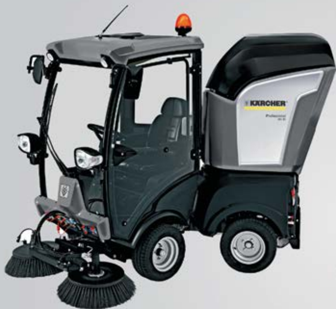
Коммунальная машина MC 50 Объем бункера 500 литров
