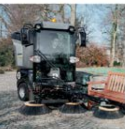
Коммунальная машина MC 50 Объем бункера 500 литров
