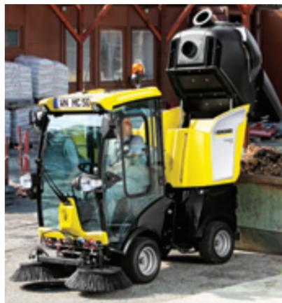
Стандартная комплектация: полностью остекленная комфортная кабина с выдвижной крышей и открывающимся боковым стеклом, штатная розетка 12 В, отопитель, регулируемое подпружиненное сиденье, осветительное оборудование в соответствии с требованиями к эксплуатации транспорта, рабочее осветительное оборудование, счетчик часов эксплуатации машины и подметального механизма, проблесковый маячок, устройство изменения направления вращения боковых щеток.
