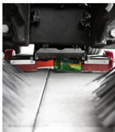
Вместительность мусоросборника равна 500 л, а в бак для чистой воды её можно залить целых 165 л. Вода подаётся на очищаемую поверхность перед щётками и во всасывающее устройство, снижая образование пыли при работе. Снизить расход воды поможет система рециркуляции, доступная для всех машин. В этом случае, собираемая вместе с мусором вода отделяется от него в мусоросборнике и снова подаётся во всасывающий канал.
