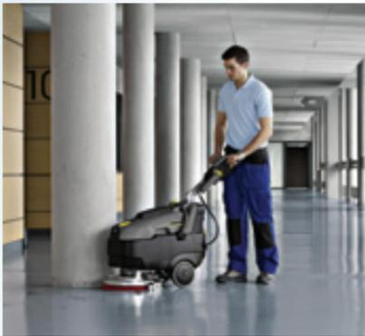
Среди новинок этого сезона – поломойная машина BD 40/12 C Vp Pack. Аппарат рассчитан на уборку площадей от 100 до 700 м<sup>2</sup> и позиционируется между поломойными машинами BR 30/4 Vp и BD 40/25 C Vp.
